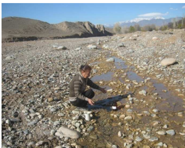
Фото 6.3.1. Отбор проб поверхностных вод бассейна р. Сумсар (Резаксай)
