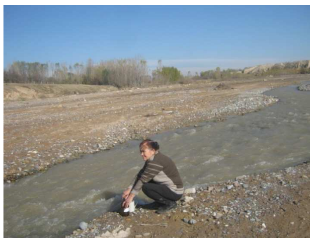
Фото 6.3.1. Отбор проб поверхностных вод бассейна р. Сумсар (Резаксай)
