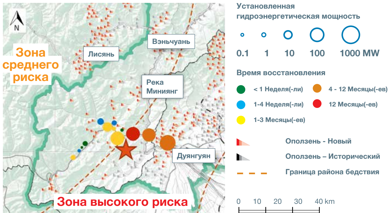
Рис. 38. Системы электрической генерации и передачи в подверженных опасности районах округа Вэньчуань, Сычуань, Китай вблизи эпицентра Вэньчугского землетрясения 2008 года.
